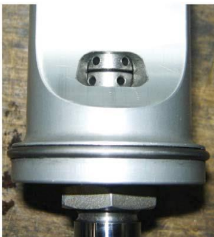
Dubbla justeringar för enkeltörsdämpare
